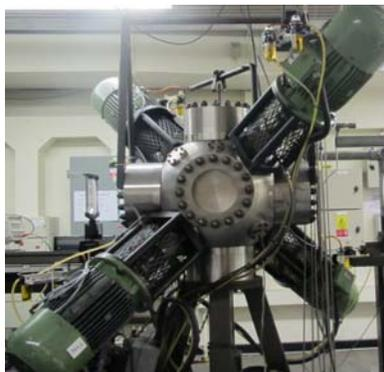
**Fig. 1:** Mk2 Combustion Bomb.
