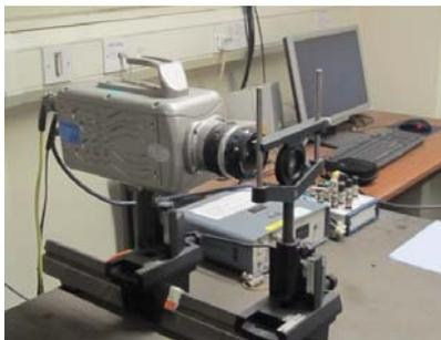
**Fig. 2:** High Speed Schlieren Cine-Photography.
