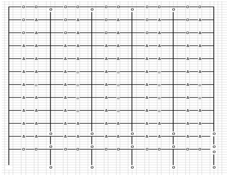
Gambar 5.32 Lokasi Terjadinya Sendi Plastis dari Hasil Analisis Pushover untuk Bangunan 12-lantai pada Portal Eksterior 1000 Tahun
