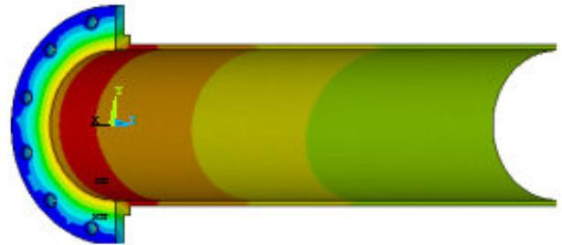
**Gambar 8.** Displacement untuk Flens pada Pipa
