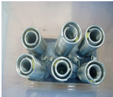
Gambar 1. Elektroda SS 304 Bentuk Spiral.
