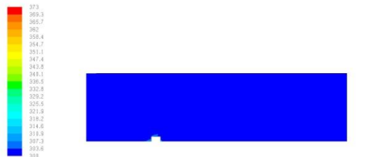
Gambar 11. Temperatur aliran di sekitar obstacle dengan model turbulen SKW
