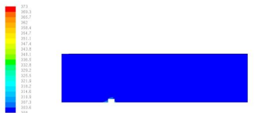
Gambar 12. Temperatur aliran di sekitar obstacle dengan model turbulen SSTKW.
