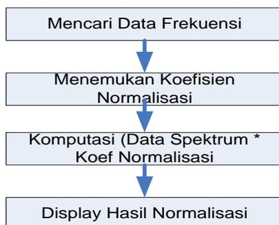
Gambar 2. Blok diagram proses normalisasi
