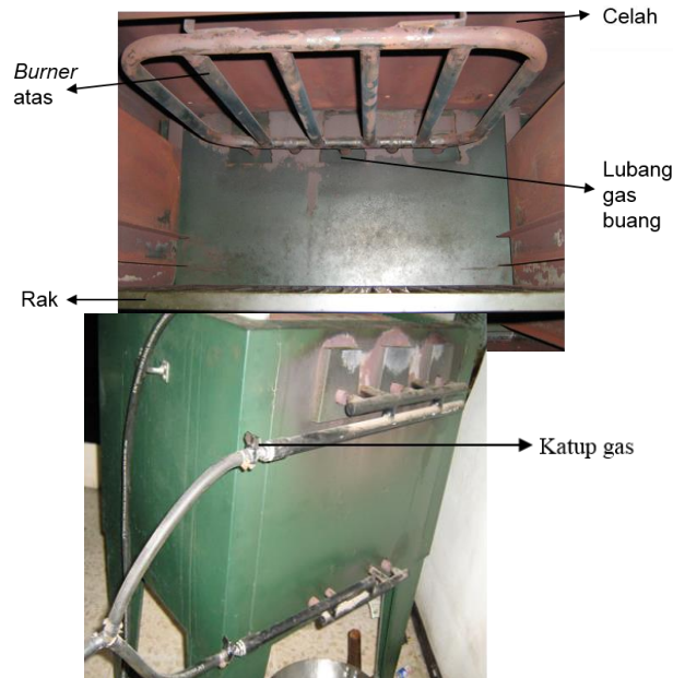
Gambar 2. Burner atas, lubang gas buang dan ruang panggang.
