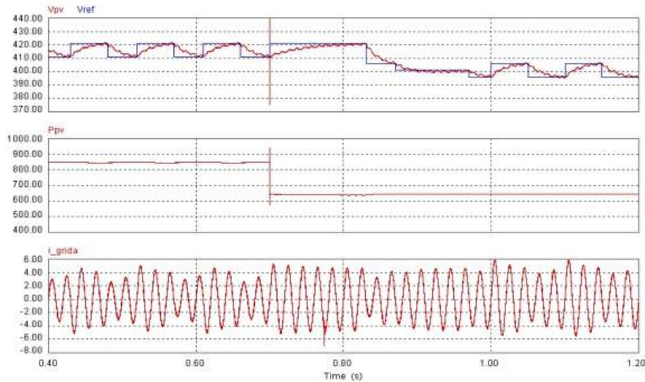
**Gambar 4.19. Tegangan keluaran panel PV dan tegangan referensinya (atas); Daya panel PV (tengah); Arus grid (fase A) (bawah) ketika tingkat radiasi matahari berubah**
