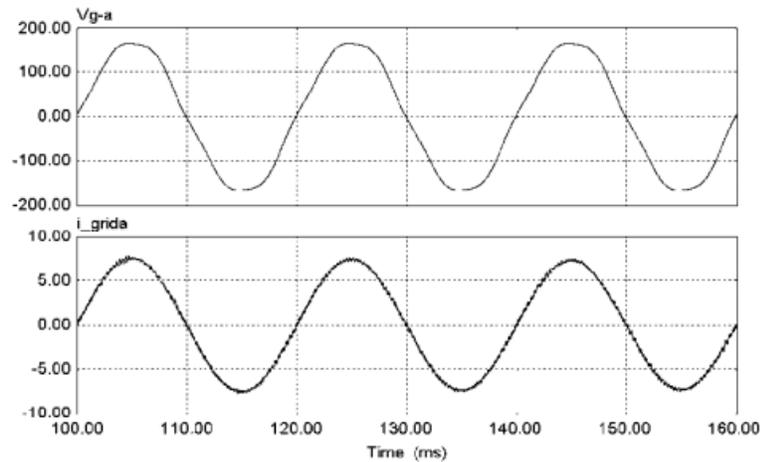
**Gambar 3.17. Tegangan dan arus grid (fasa A)**
