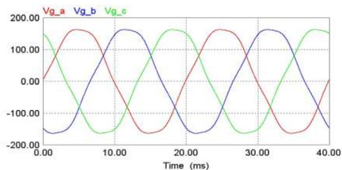
Gambar 3.12. Tegangan grid tiga fasa
