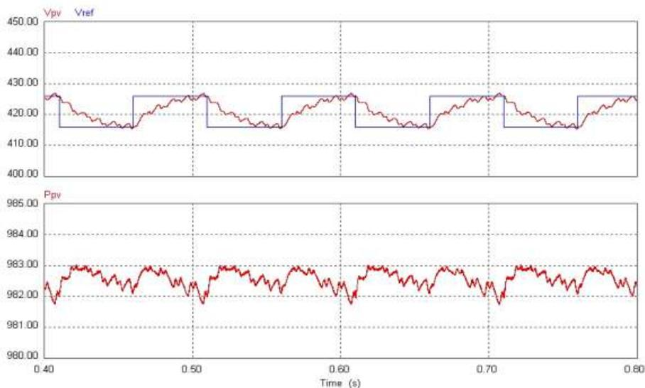
**Gambar 4.16. Tegangan keluaran panel PV dan tegangan referensinya (atas);
