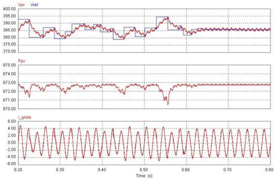
Gambar 4.26. Tegangan dan daya keluaran panel PV, dan arus grid ketika panel PV tertutup sebagian.
