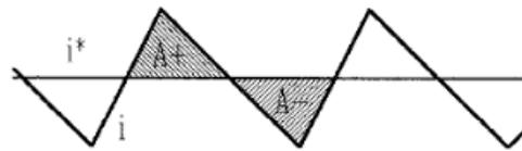
**Gambar 3.7.** Kerja kendali arus (tracking) dengan PRCC.
