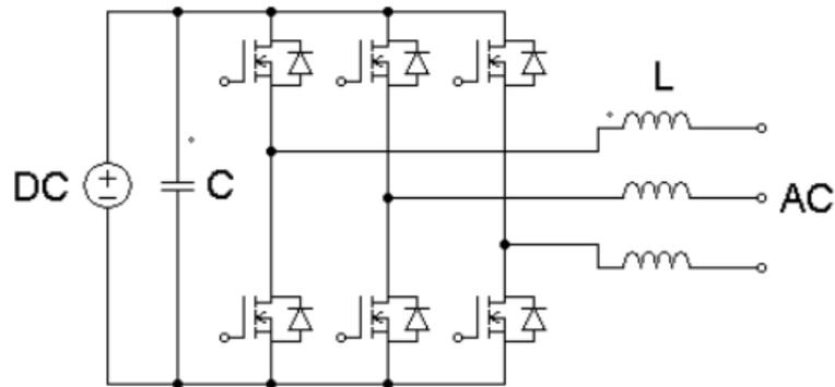
Gambar 2.3. VSI dengan MOSFET dan Dioda anti-paralel
