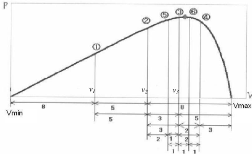
Gambar 4.5. Proses Pencarian Titik Maksimum dengan Fibonacci
