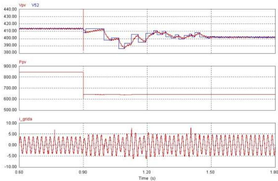
**Gambar 4.24. Tegangan referensi dan tegangan keluaran PV (atas); daya keluaran panel PV (tengah); arus grid (fasa A)(bawah) ketika tingkat radiasi matahari berubah**
