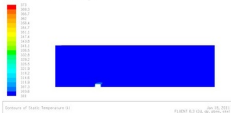
Gambar 9. Temperatur aliran di sekitar obstacle dengan model turbulen SKE
