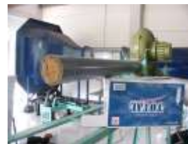
Gambar 3. Peralatan untuk menguji penurunan tekanan aliran udara melalui bantalan
