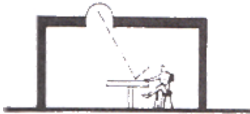
Gambar 4.6 Pemantulan terselubung ( veiling ) merupakan masalah yang sering ditemukan pada pencahayaan yang berasal dari atas (Lechner, 2001)
