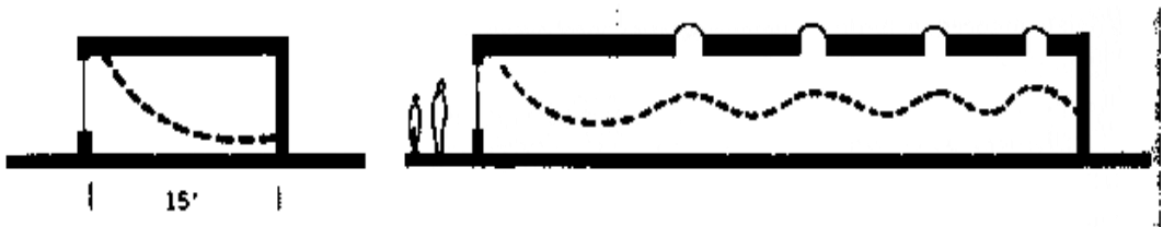
Gambar 4.2 Ketika pencahayaan alami dari bukaan terbatas pada dinding luar, bukaan pada atap akan mampu meratakan pencahayaan sepanjang luas ruangan yang terbatas (Lechner, 2001)
