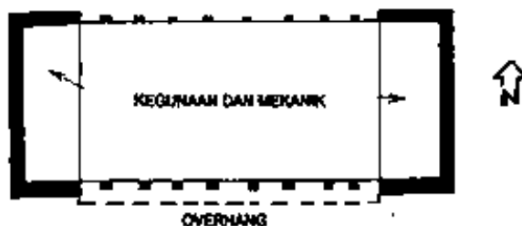
Gambar 4.1 Perencanaan yang ideal untuk pencahayaan alami dan juga untuk pengendalian umum sinar matahari adalah dengan menempatkan semua bukaan pada sisi bagian Utara dan Selatan (Lechner, 2001)
