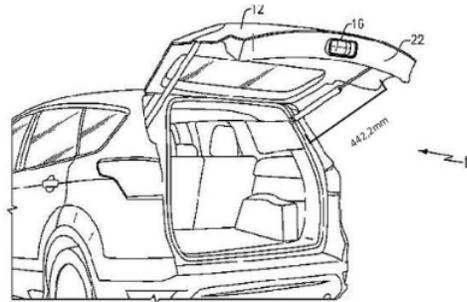
Gbr. 5 Peletakan aktuator di dalam kendaraan
