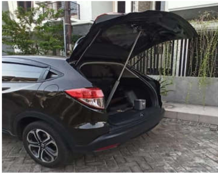
Gambar 7. Posisi Aktuator Maksimum Membuka
