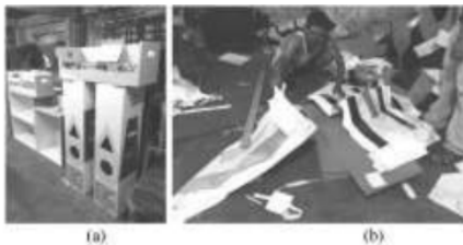
Gambar 45. (a) Penyempurnaan finishing mebel; (b) Proses menjahit kulit sintetis pada matras.
