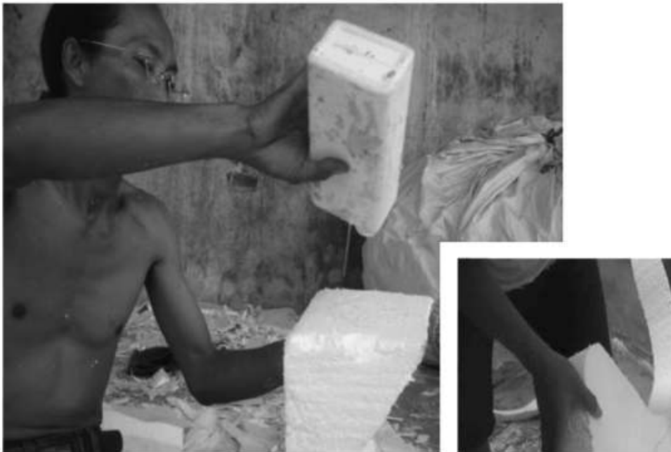
Gambar 28, 29 Teknik Penyambungan styrofoam dengan lem PVAc.
