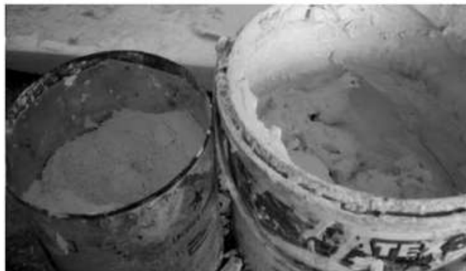
Gambar 15 Plamir untuk menghaluskan permukaan
