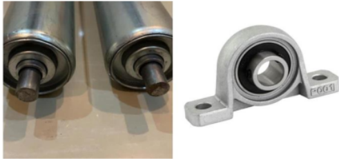
Gambar 1. Gravity roller dan bearing block yang digunakan
