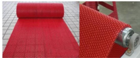
Gambar 2. Polyvinyl chloride (PVC) anti-slip mat yang digunakan sebagai material konveyor
