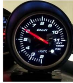
Gbr. 5 Pembacaan temperature gas buang
