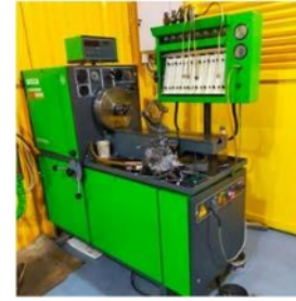
Gbr. 6 Kalibrasi dan pengujian pompa injeksi
