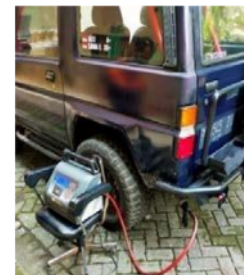
Gbr. 3 Pengukuran opasitas gas buang.
