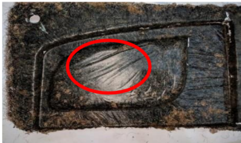
Gambar 2. Kerutan pada prototype
