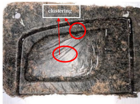
Gambar 4. Clustering di permukaan prototype
