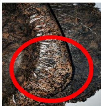
Gambar 3. Void pada prototype
