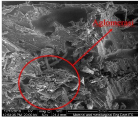
Gambar 7. Foto mikro pada permukaan atas sampel
