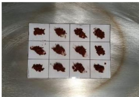
Gambar 2. Pencampuran PP dengan serbuk biji salak sebelum proses hot press
