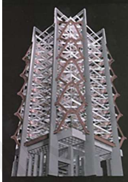
Gambar 136b. Sistem Struktur CEC Tower Sumber: (Bellen, 2000)
