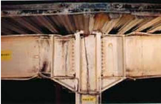
Gambar 133c. Deformasi terhadap Beban Siklik pada Spesimen Komposit Sumber: Yu (2000), https:// www.iitk.ac.in/nicee/wcee/ article/0660.pdf , diunduh Mei 2022
