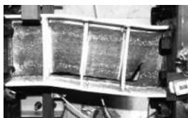
Gambar 81a. Mekanisme Kegagalan Struktur Link Pendek
