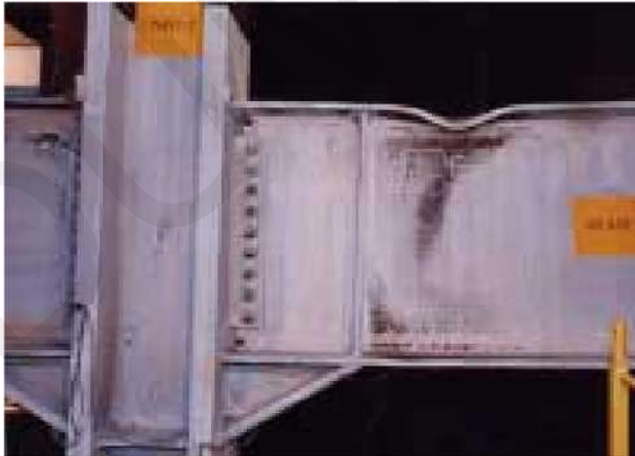
Gambar 133b. Deformasi terhadap Beban Siklik pada Spesimen Nonkomposit
