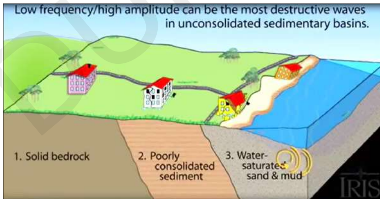
Gambar 6b. Keruntuhan Karena Liquefaction Bangunan di Tanah Paling Tepi (*)
