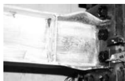
Gambar 81c. Mekanisme Kegagalan Struktur Link Panjang
