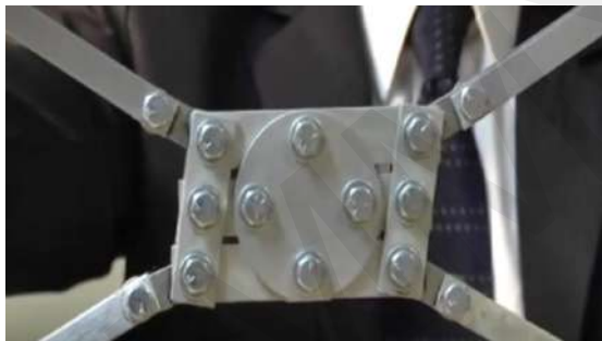
Gambar 102b. “Pall” Cross-Bracing Damper dalam Posisi Bergeser
