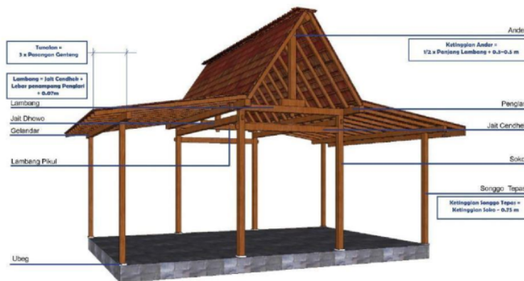
Gambar 5. Struktur bangunan osing Sumber : Perbub Banyuwangi No 11 Tahun 2019
