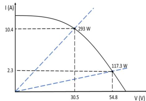
Gambar 7. Kurva I-V: Perubahan Titik Kerja Panel Surya.
