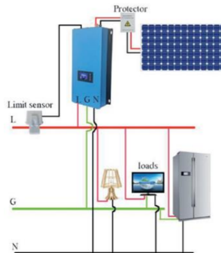
Gambar 5. Posisi Pemasangan Limit Sensor (Sumber: GWL GridFree Inverter Limit Function User Manual, p.2)
