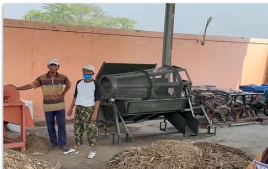
Gambar 1. Mesin pengayak pupuk kompos jenis rotary di desa Mojotrisno.
