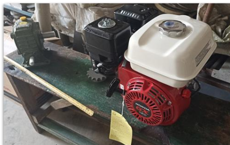
Gambar 2. Motor bensin sebagai sistem tenaga penggerak
