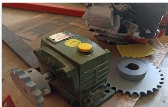
Gambar 3. Reducer dan sistem transmisi sesuai kebutuhan
