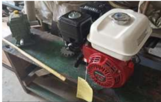
Gambar 2. Motor bensin sebagai sistem tenaga penggerak
