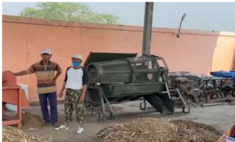
Gambar 1. Mesin pengayak pupuk kompos jenis rotary di desa Mojotrisno.
