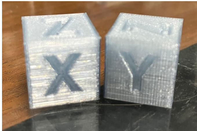
Gambar 12. Hasil Cetak 3D dengan Menggunakan Filamen Berbahan Dasar Botol Plastik PET Bekas
