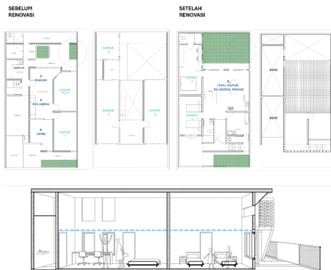
Gambar 3. Pengurangan jumlah ruangan dalam renovasi
