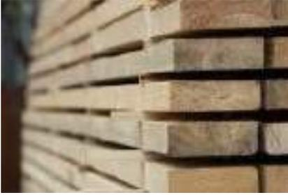
**Gambar 14.1** Penumpukan Kayu pada Saat Proses Pengeringan secara Alami
