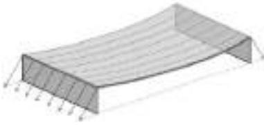
**Gambar 9.7a** Susunan Paralel Kabel Tunggal dengan Beban Permanen (Gb. 6a) atau Atap *Shell* Terbalik (Gb. 6b)
