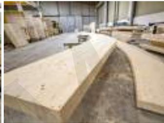
**Gambar 14.27** Busur *Glulam* dalam Proses di Pabrik
