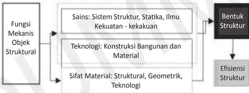
**Gambar 1.2** Hubungan Bentuk – Struktur – Material dan Efisiensi
