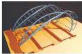
**Gambar 15.29** Struktur Busur *Space Truss*
