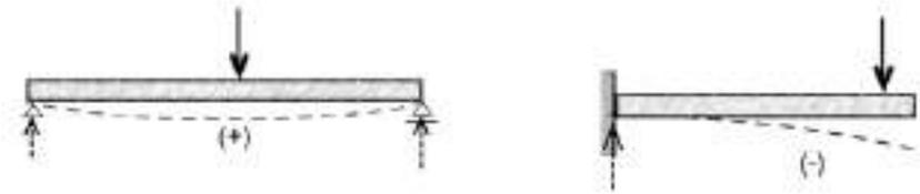
**Gambar 5.2** Deformasi pada Balok dan Balok Kantilever
