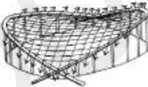
**Gambar 9.12d1** Susunan Ortogonal Kabel Kabel Satu Lapis
