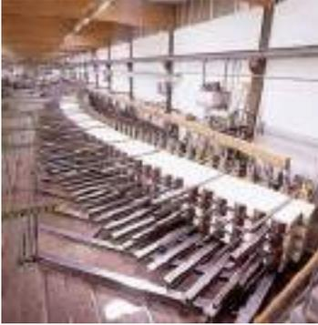
**Gambar 14.30** Proses Pengepresan Balok Lengkung (Busur) *Gluelam*
