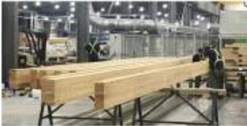
**Gambar 14.26** Balok *Glulam* dalam Proses di Pabrik
