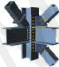
**Gambar 14.63** Konstruksi Join Kolom-Blok-Bracing
