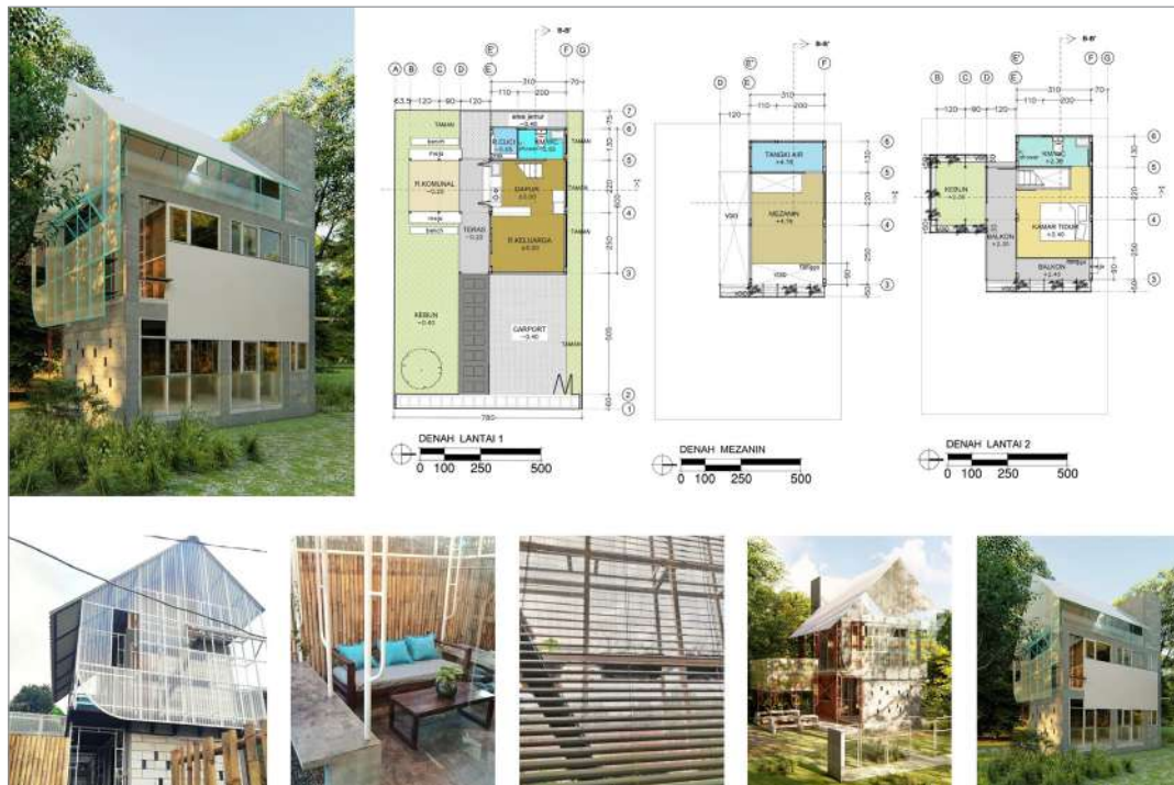
Gambar 4. Rumah tumbuh dengan perancah sebagai elemen struktur fleksibel dan adaptif Sumber: diolah dari (Akanoma, 2021)
