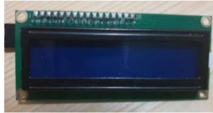
Gambar 7. Modul LCD 16x2
