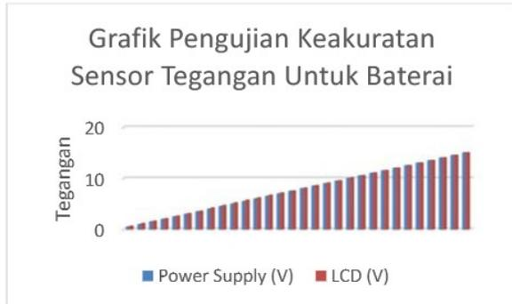
Gambar 10. Grafik Pengujian Keakuratan Sensor Tegangan Untuk Baterai
