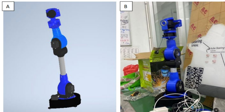
Gambar 7. Robot 6 DoF (a) desain pada software desain dan (b) hasil manufaktur
