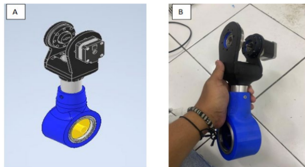
Gambar 2. Joint 2 (a) desain pada software desain dan (b) hasil manufaktur
