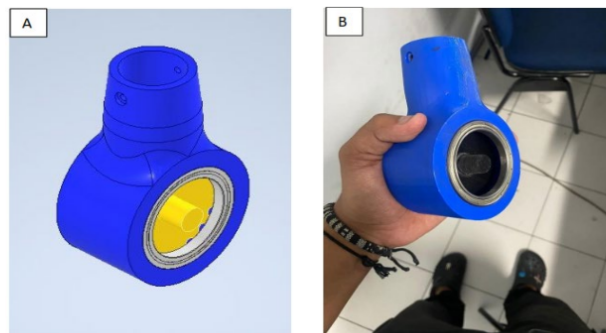
Gambar 3. Joint 3 (a) desain pada software desain dan (b) hasil manufaktur
