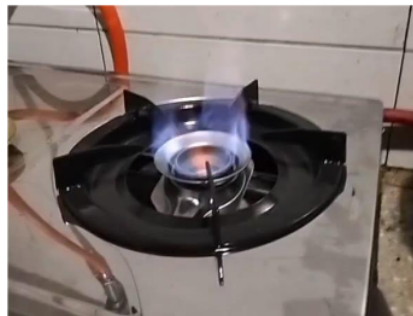
Gambar 9. Nyala kompor hasil biogas
