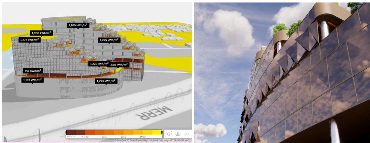
Gambar 3. Karya Michael Devin, simulasi matahari pada sisi barat bangunan menggunakan Autodesk Forma dan penerapan fasad kinetik pada sisi barat bangunan
