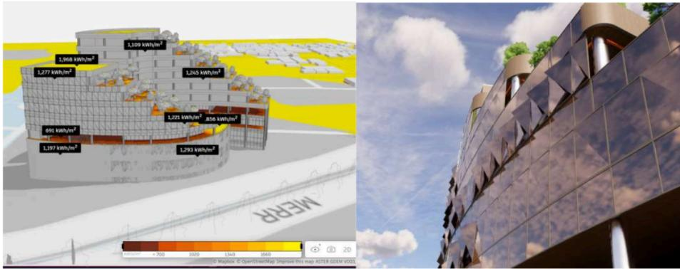
Gambar 3. Karya Michael Devin, simulasi matahari pada sisi barat bangunan menggunakan Autodesk Forma dan penerapan fasad kinetik pada sisi barat bangunan
