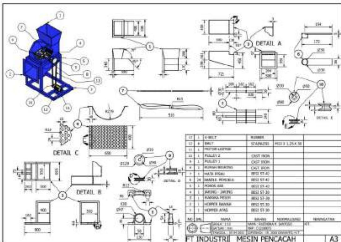
Gambar 4 Gambar teknik dari mesin pencacah pakan ternak.
