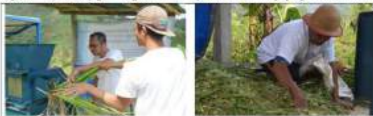
Gambar 10 a dan b) Uji coba chopper listrik bertanaga surya dengan peternak di Dusun Turi.
