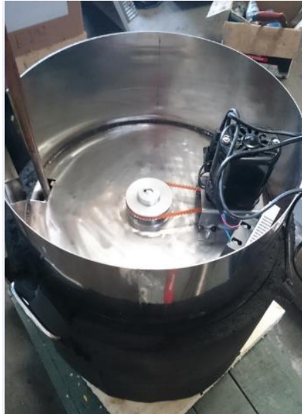
Gambar 5.5 Proses assembly tangki dan pengaduk
