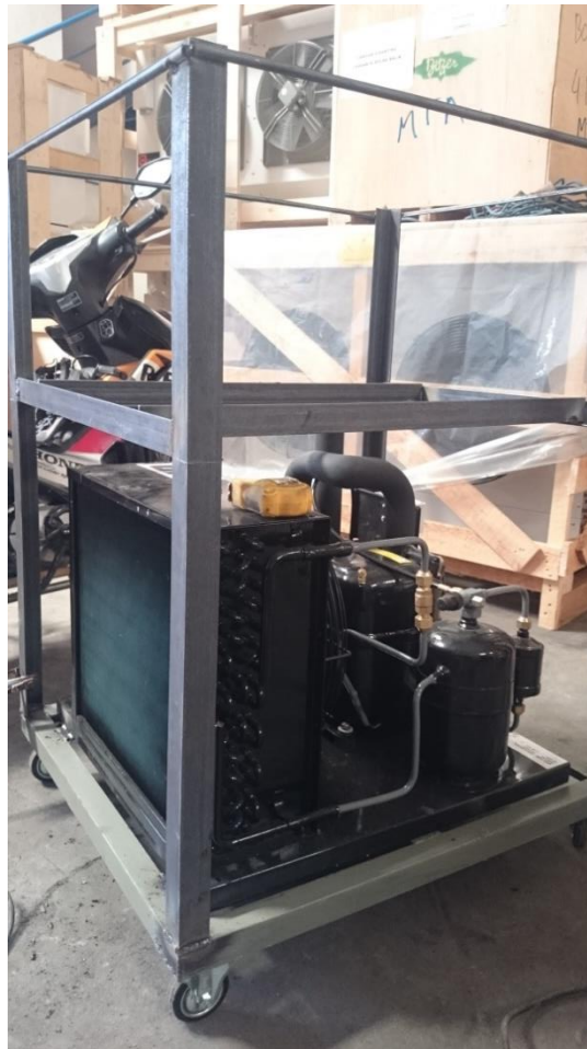
Gambar 5.29 Pembuatan kerangka condensing unit
