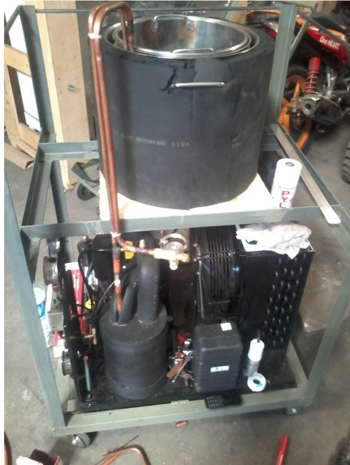
Gambar 5.22 Instalasi joint antara pipa pada sistem pendingin
