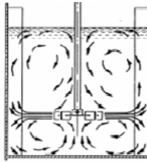
Gambar 5.1 Arah tekanan pada tangki
