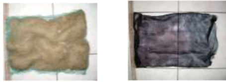
a. serabut dalam jala b. pad asli Gambar 5. Bantalan serabut dalam jala-jala dan pad asli
