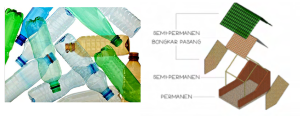
Gambar 4.20 — Gambar detail arsitektural yang menjelaskan pengaplikasian Material daur ulang botol plastik yang akan dipergunakan dalam pelaksanaan penutup atap lapak Pasar Cendani.
