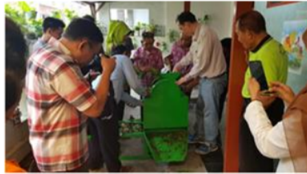
Gambar 4. Proses Demonstrasi dan Ujicoba Alat Perajang Sampah Dengan Menggunakan Penggerak Motor Bensin
