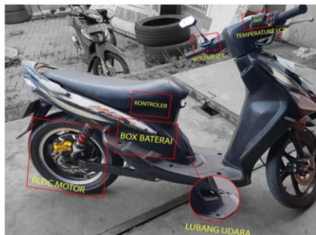
GAMBAR 6. Sepeda motor listrik hasil konversi
