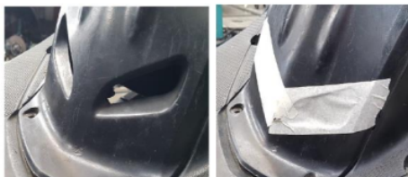
GAMBAR 4. Pengujian saluran ventilasi udara terbuka (kiri) dan saluran ventilasi udara tertutup (kanan)
